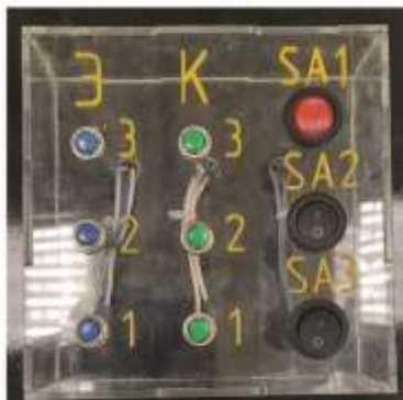
Фото 1. Кнопочный пост управления стенда
